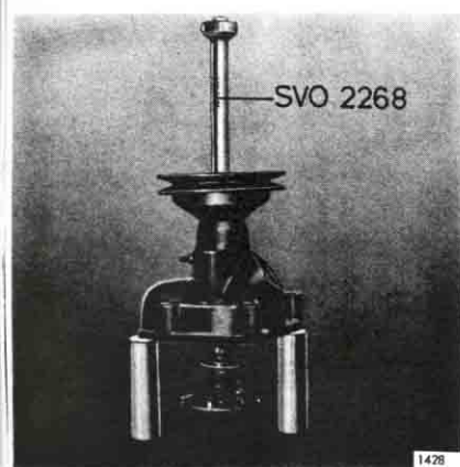
Fig 49. Demontering av pump-axel.
