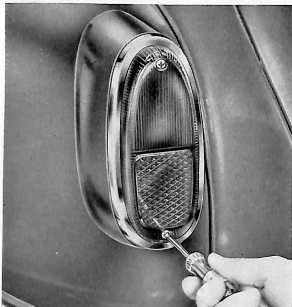
Bild 73. Demontering av glas.
