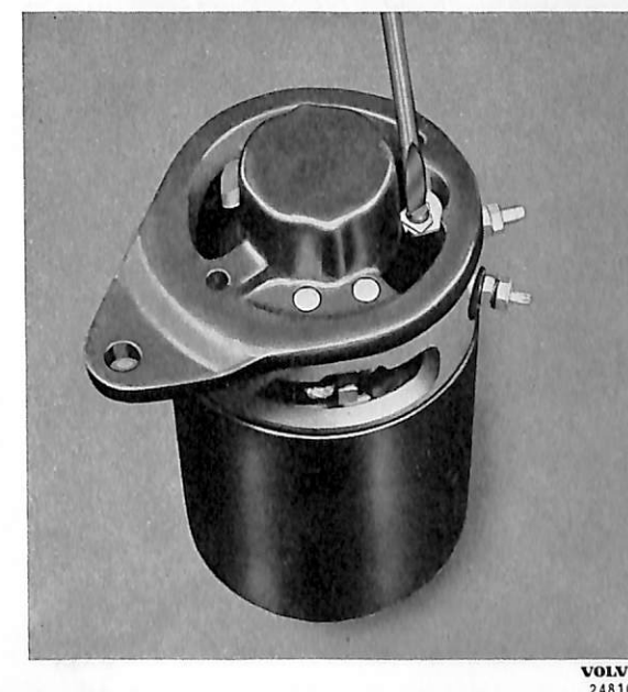
Bild 39. Demontering av förbindningsskenan.
