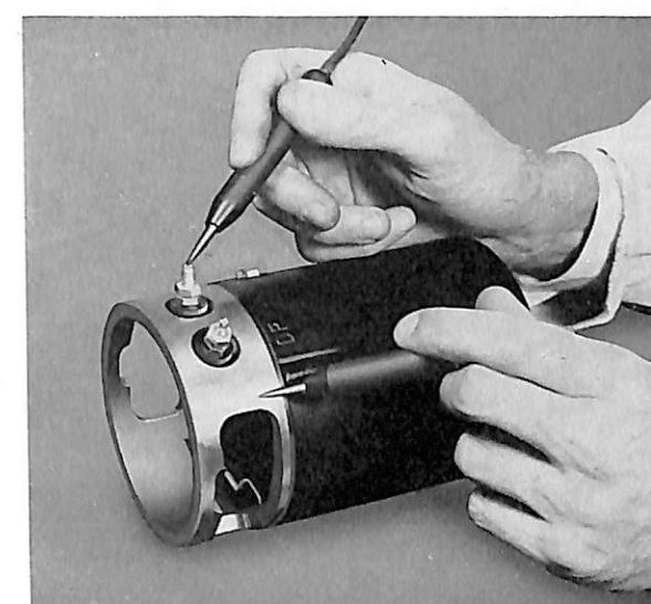
Bild 46. Provning av stator.
