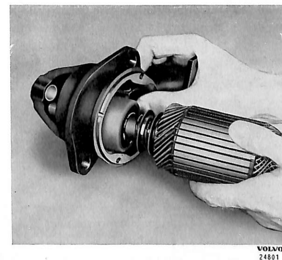
Bild 17. Demontering av drev och rotor.
