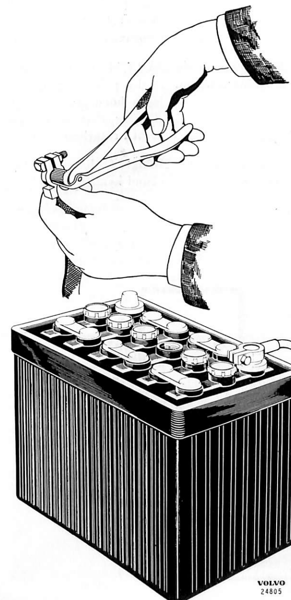
Bild 13. Rengöring av batterikabelsko.
