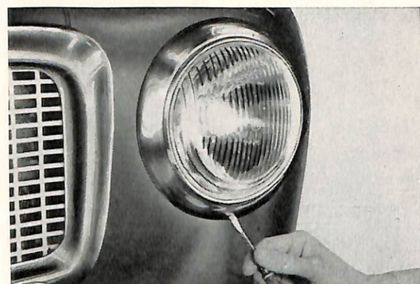
Bild 9. Lossstagning av skruv för strålkastarsarg.
