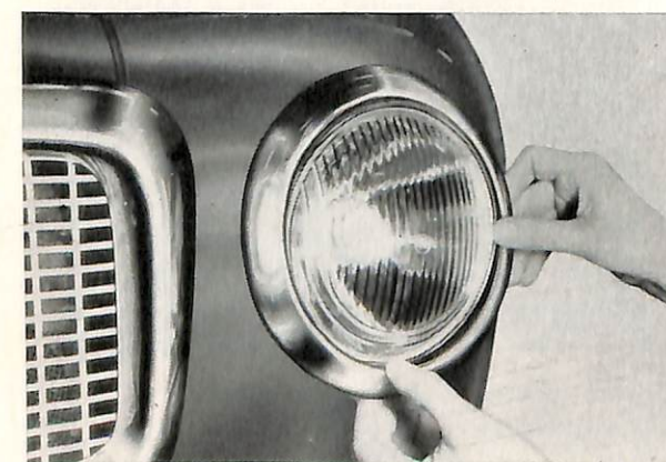
Bild 10. Demontering av strålkastarsarg.
