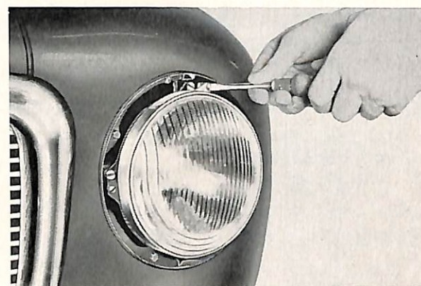
Bild 11. Demontering av hållring.
