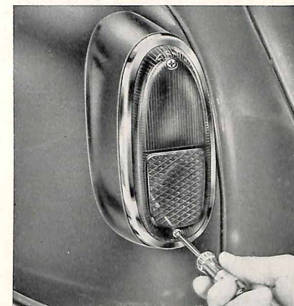
Bild 16. Demontering av glas.
