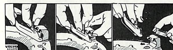
Bild 12. Demontering av hävarmar.
