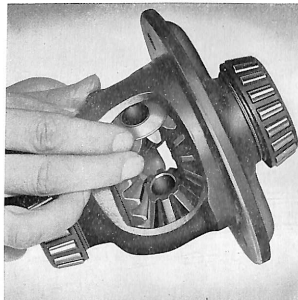
Bild 16. Mont. av differentialhjul.
